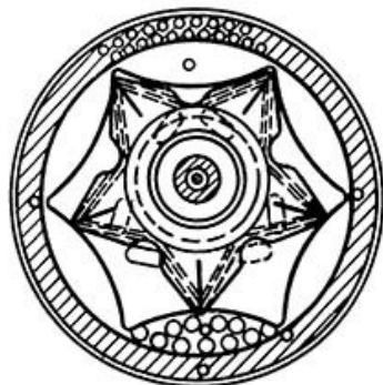
Рис. 6. Схема роторно-поршневого двигателя Сансо де Лаво (1938 г.)
